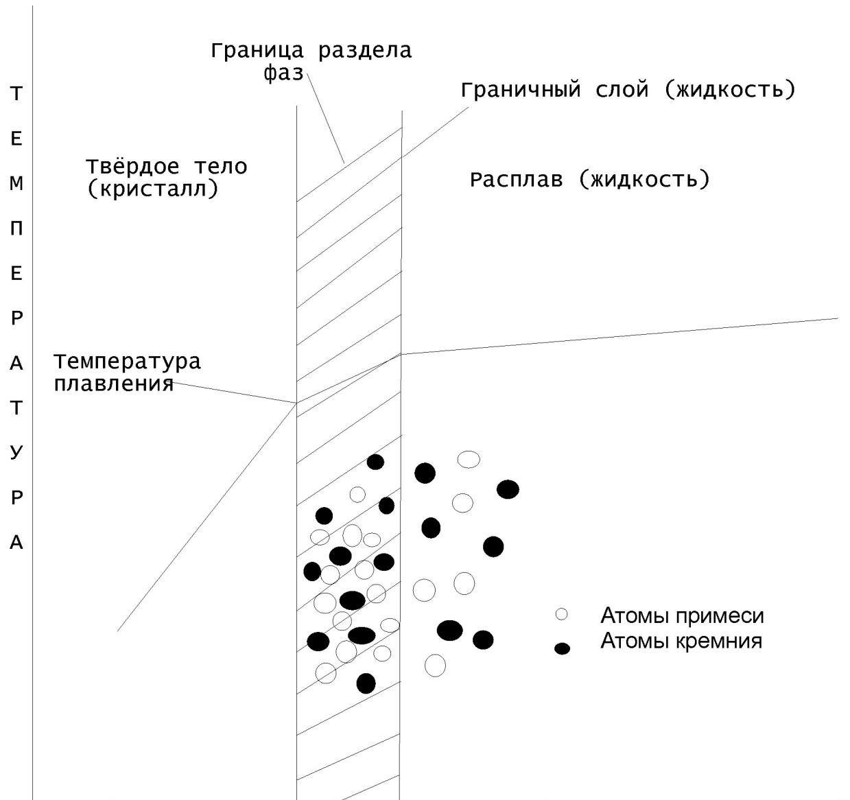
Рис.4 График температурного режима при формировании кремниевой подложки
