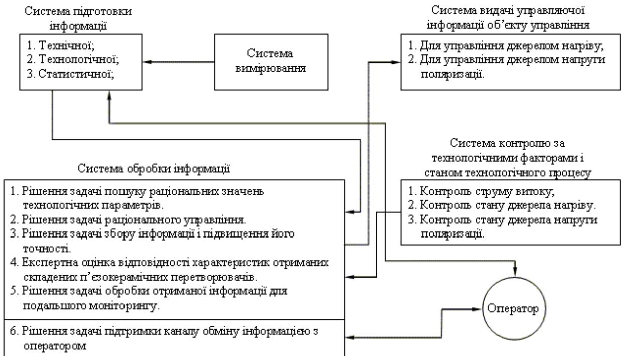
Рис. 1 Структура інформаційної моделі автоматизованої системи управління технологічним процесом пайки складених п'езокерамічних перетворювачів
